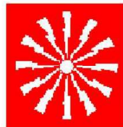
PULSANTE DI ALLARME ANTINCENDIO
